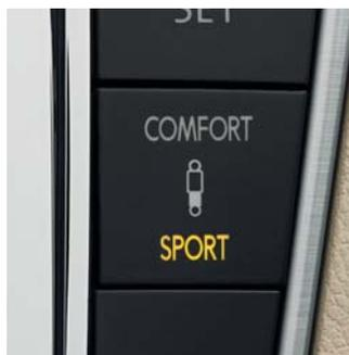
La nouvelle régulation pilotée de l'amortissement. Un simple bouton suffit pour choisir un style de conduite, normal, sportif ou confortable.
